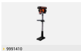
Perforadora de Pie 16 mm 12 Velocidades / Mod. PP16P - 180 - 2.740 rpm - Ø Máx. Mandril: 16 mm - Recorrido man. 80 mm - Recorrido masa: 710 mm - Alt. Total: 1610
